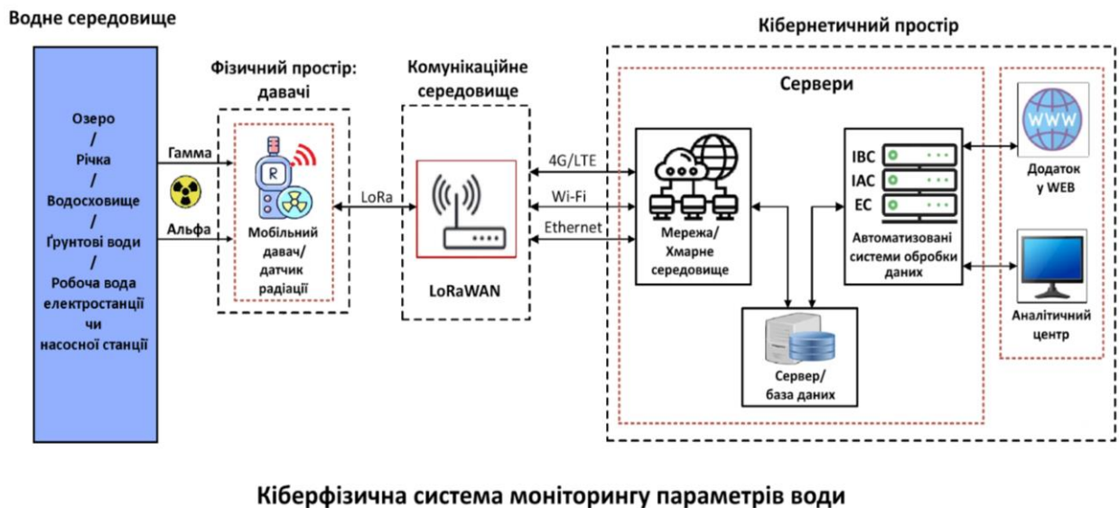
Рис. 1. Архітектура КФС дистанційного моніторингу параметрів води
