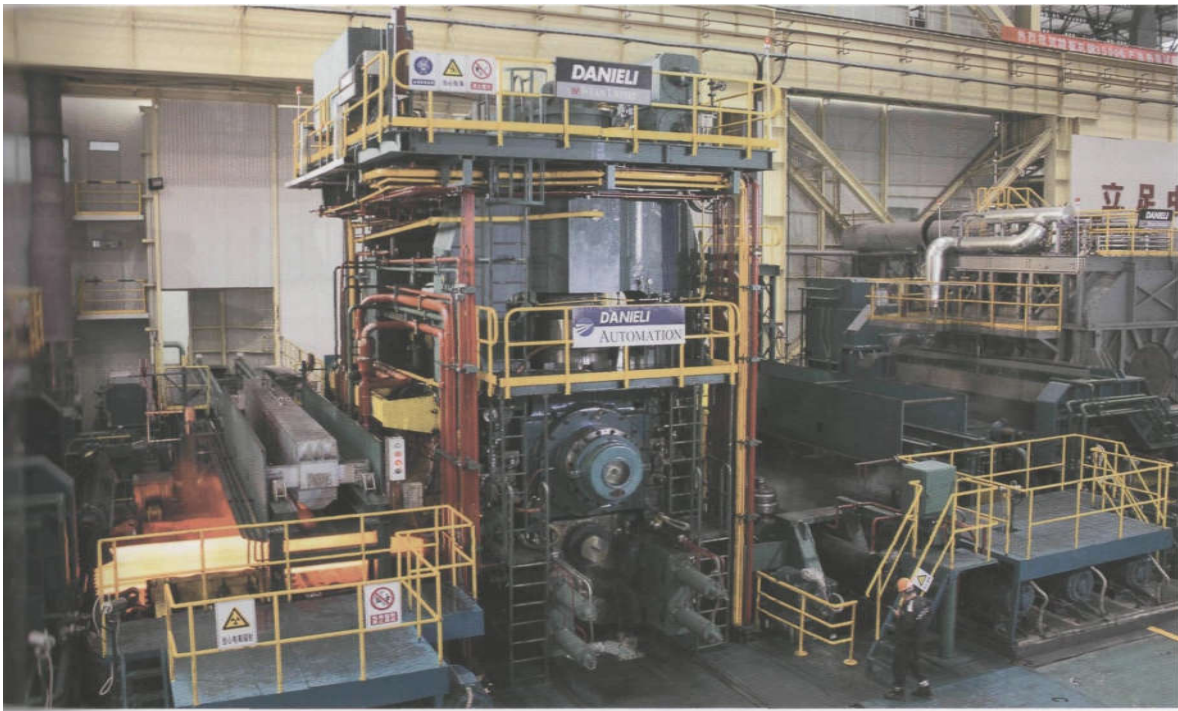
Рис. 1 – Новий товстолистовий стан/ Стеккеля та комплекс широкого товстолистого прокату у м. Джиангун , а також слябова МБЛЗ для слябів шириною до до 3500 мм
