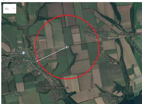
Рисунок 1 – Зона ураження при розльоті уламків після вибуху на насосній станції, що перекачує аміак (результати розрахунку для кута вильоту \alpha = 30^\circ ).
