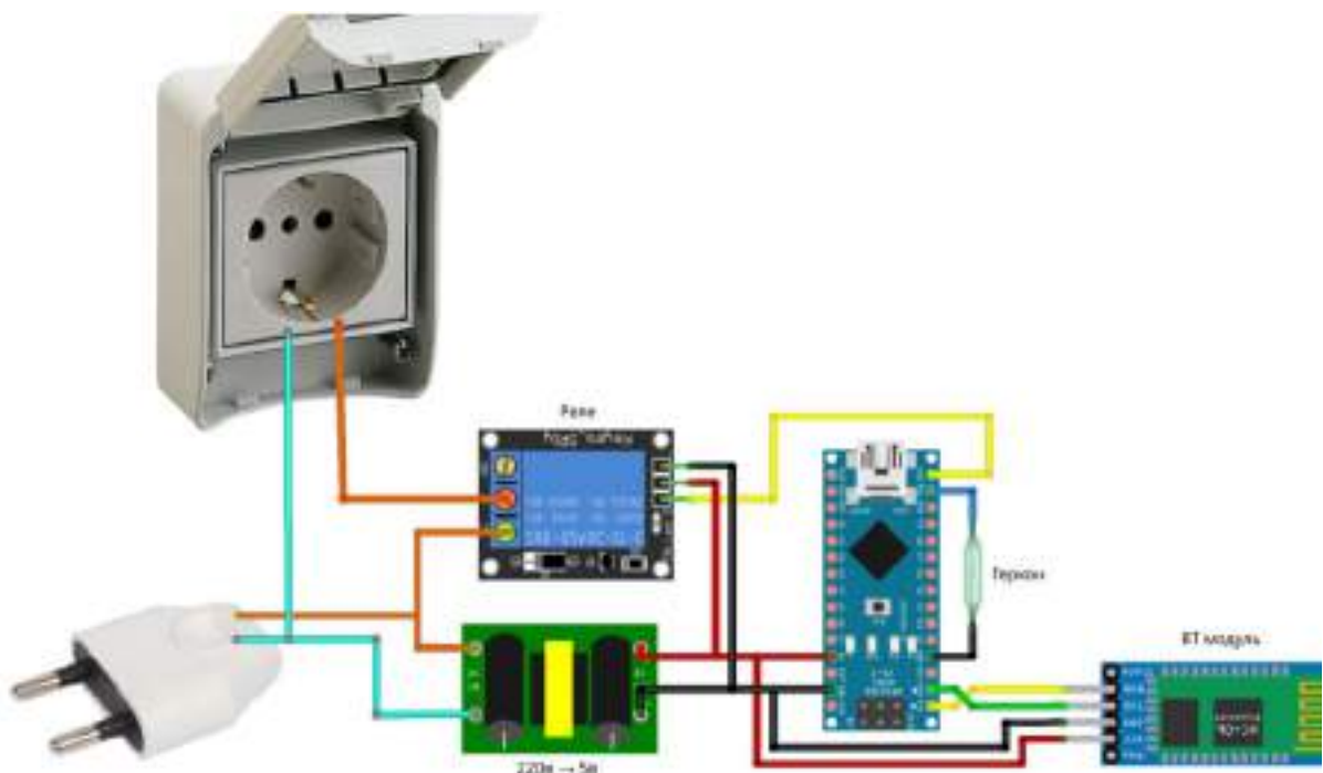
Рисунок 1 — Схема підключення елементів пристрою
