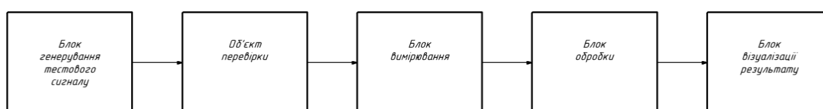
Рис.1 – Блок-схема комплексу реєстрації дефектів в металевих зразках
