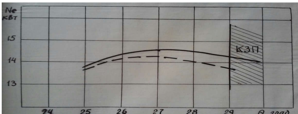
Рис.1. Детонаційна характеристика двигуна на метанолі ( \epsilon=11 ; n=2000 \text{ хв}^{-1} ; — t_{\text{п}} = 25^{\circ}\text{C} ; -- t_{\text{п}} = 80^{\circ}\text{C} )
