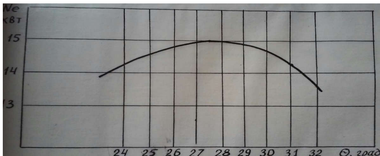
Рис.3. Детонаційна характеристика двигуна на метанолі ( \epsilon=12,8 ; n=2000 \text{ хв}^{-1} ; — t_{\text{п}}=25^{\circ}\text{C} )
