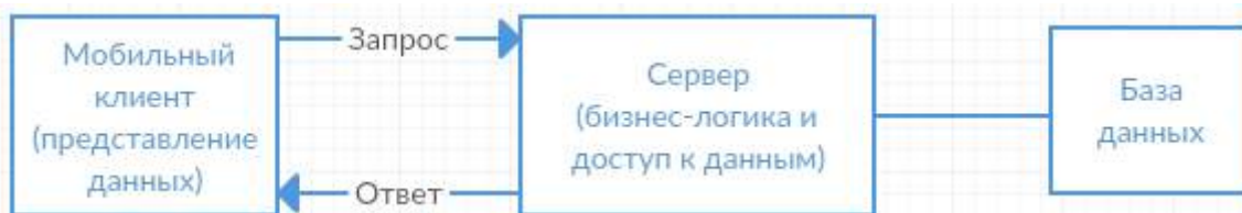
Рис. 1. Двухуровневая клиент-серверная архитектура с "тонким" клиентом
