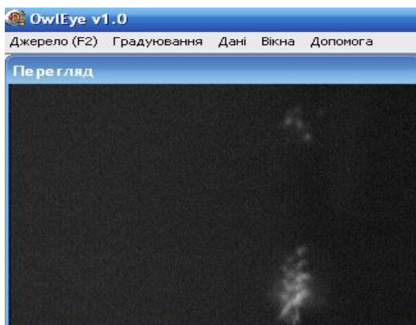
Рис. 1. Світіння дефектів сонячної батареї, збільшення у 60 раз
